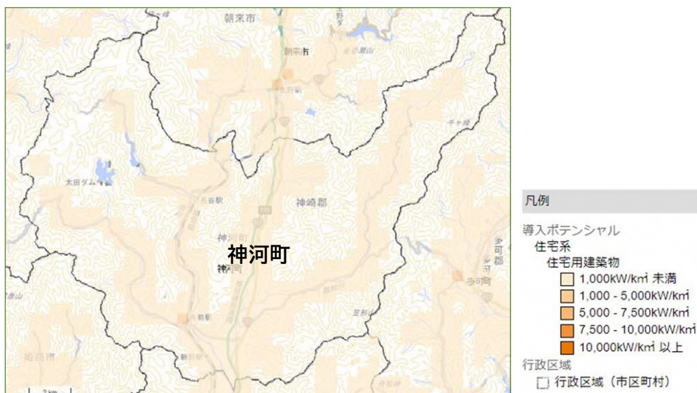
図4-1 住宅系建築物への太陽光発電導入ポテンシャル (資料:再生可能エネルギー情報提供システム(REPOS:リーポス)【環境省】)
