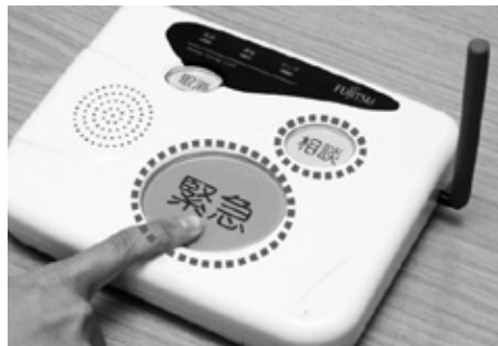
緊急通報装置
