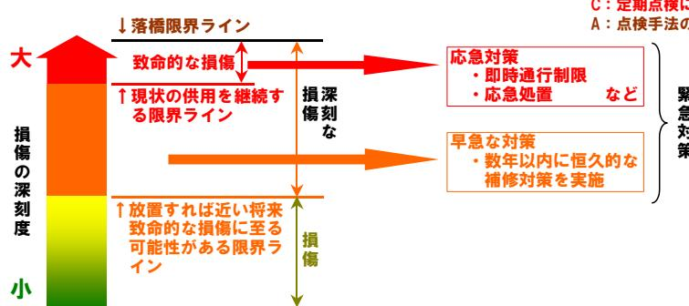
**致命的な損傷:** 現状の供用を継続することが困難であると判断される損傷を指す。直ちに通行制限や応急処置などの応急対策を施す必要がある。
