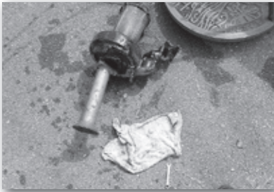
▲ポンプに詰まっていたタオル
